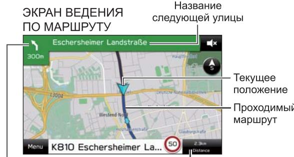
Расстояние до следующего поворота и стрелка, указывающая направление поворота
